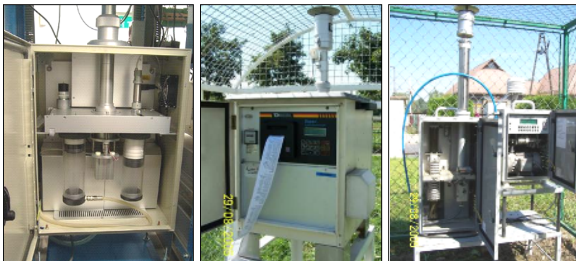
Figura 2. Campionatore gravimetrico sequenziale per il campionamento degli inquinanti particellari.
